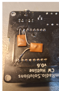
Die Speisungen des Wifi Moduls 5V und 3.3V wurden auch noch abgeblockt
