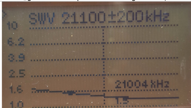
Resonanz und SWR etwas zu hoch fürs CW Band jedoch OK. Die 15m Spule ist voll zusammengepresst! 4W. 15m könnte eine Windung mehr gebrauchen!
