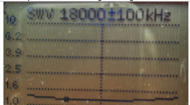
12m Resonanz und SWR um 1.3 OK, breitbandig 12m Spule eine auf 3 Wdg. verringert.
