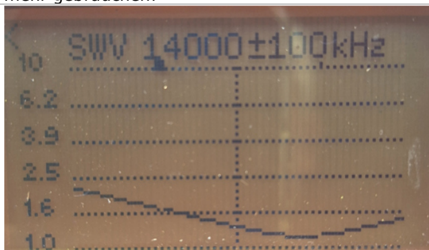
Resonanz und SWR im CW Band OK! 20m Spule durch spreizen verringert!
