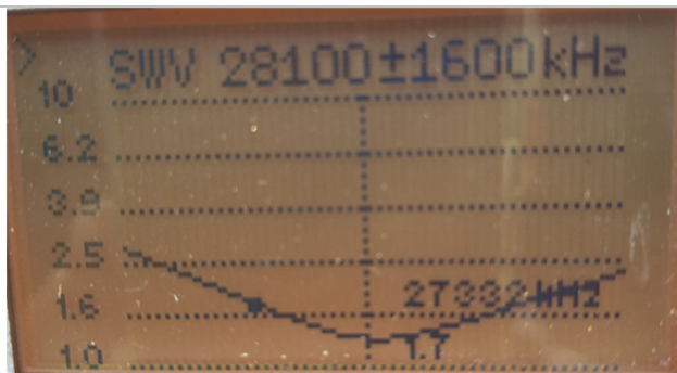
10m Resonanz OK, SWR um 1.3 OK, breitbandig Beide „grüne“ 10m Spulen auf 2 Wdg. erhöht, OK!
