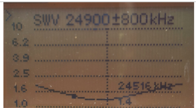
12m Resonanz und SWR um 1.3 OK, breitbandig 12m Spule eine auf 3 Wdg. verringert.
