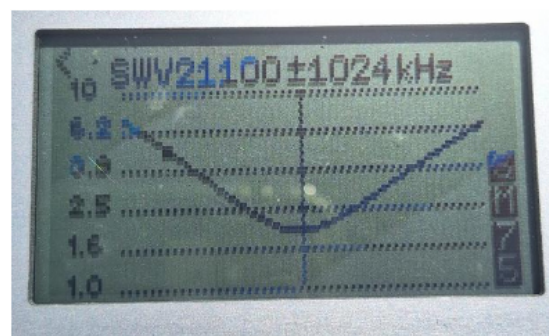
Resonanz ist im CW Band OK aber leicht zu hoch
