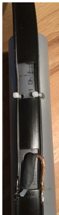
Einspeisung Koax an der 450 \Omega Leitung
