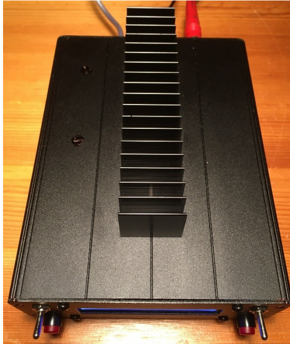
Abbildung 3 Ansicht von oben mit dem gut dimensionierten Kühlkörper
