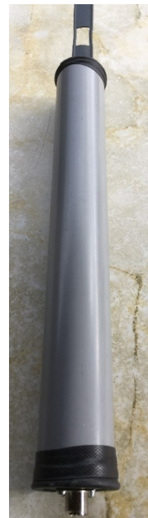
Fertige Antenne mit Schutzrohr
