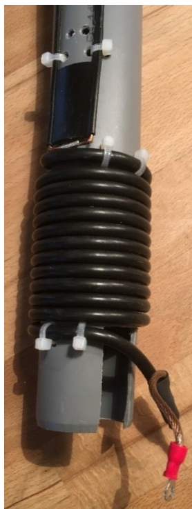
Mantelwellensperre mit RG-58 auf PVC-Rohr
