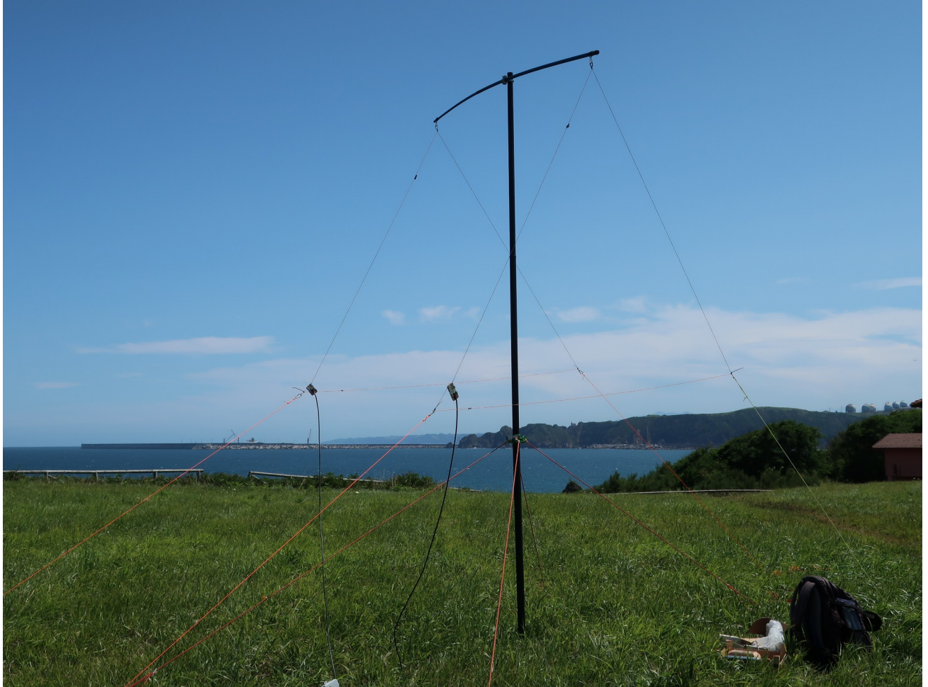
Bild 7 Die Antenne schliesslich am Strand aufgestellt und ausgemessen. Die Resonanzen der beiden Schleifen liegen gleich aber etwas zu hoch, muss noch etwas Draht beschaffen und in der einen Ecke Einfügen. Mehr Draht hatte ich anfangs nicht! Wahrscheinlich werde ich Führung der Koaxkabel noch etwas vorsehen, auch um das Kabelgewicht abzufangen. Sonst hat es recht gut gepasst.
