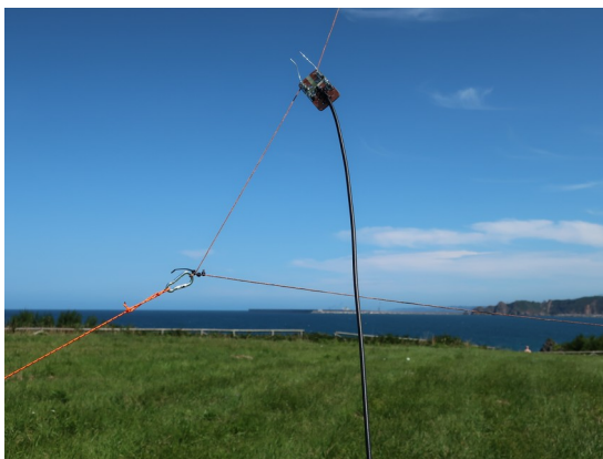
Bild 8 Die Einspeisung , Kabelführung noch verbessern
