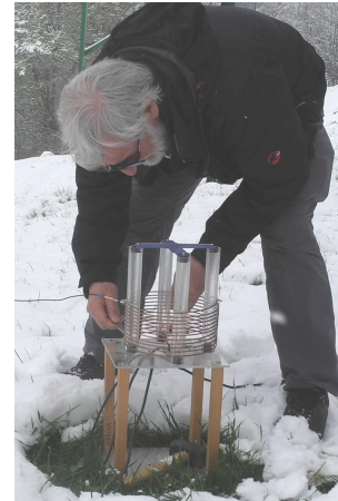
160-m-Anpassspule unbedeckt. Man sieht noch, wo das Fass gestanden hat.
